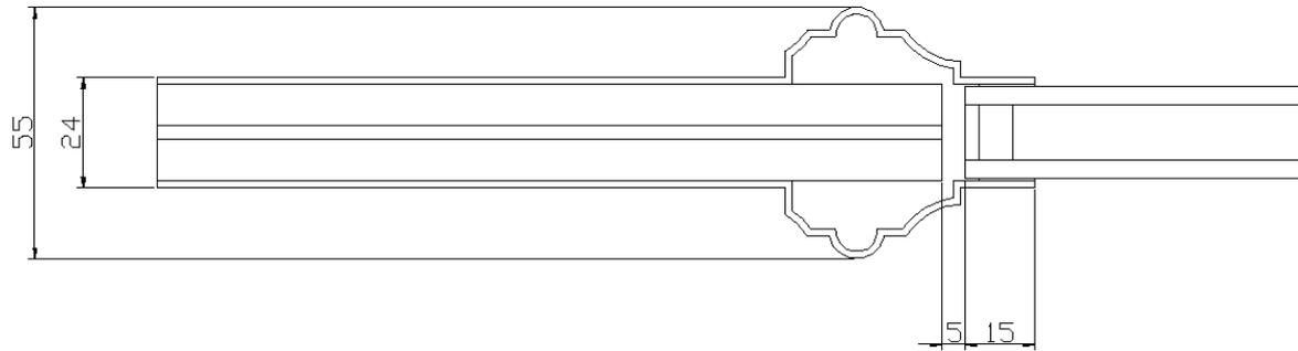
Bild 2: Querschnittsdarstellung Übergang Paneel-Verglasung
